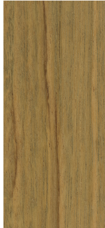
Débit sur faux quartier
